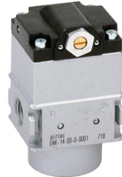
Anfahrventil zum langsamen Druckaufbau in Druckluftsystemen. Die Betätigung erfolgt durch den Sekundärdruck. Nach Erreichen von 50% des Ausgangsdrucks schaltet das Ventil komplett durch. Die Füllzeit ist einstellbar.
