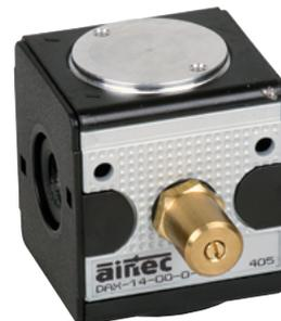
Anfahrventil zum langsamen Druckaufbau in Druckluftsystemen. Die Betätigung erfolgt durch den Sekundärdruck. Nach Erreichen von 50% des Ausgangsdrucks schaltet das Ventil komplett durch.
