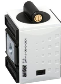
Anfahrventil zum langsamen Druckaufbau in Druckluftsystemen. Die Betätigung erfolgt durch den Sekundärdruck. Nach Erreichen von 50% des Ausgangsdrucks schaltet das Ventil komplett durch.
