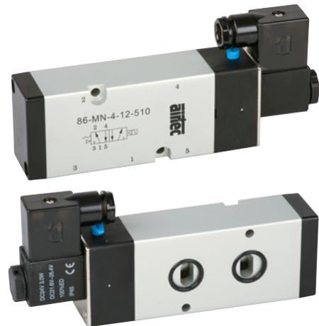
Elektrisch betätigtes Kolbenschieber-Ventil. Nach Zuschalten der Spannung wird das Ventil umgesteuert. Die Ventile sind mit einer tastend-/ rastenden Handhilfsbetätigung ausgestattet. Die Betätigung erfolgt mit Hand oder mittels Schraubendreher.
