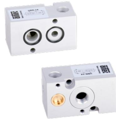
Umluftblock nach NAMUR, zur Federraumbelüftung von einfachwirkenden Drehantrieben. Befestigungsschrauben, Codierstift und O-Ringe gehören zum Lieferumfang.
