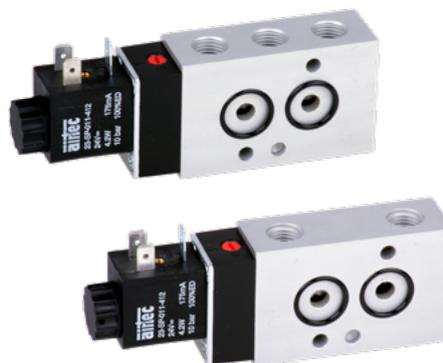
Elektrisch betätigtes Kolbenschieber-Ventil. Nach Zuschalten der Spannung wird das Ventil umgesteuert. Die Ventile sind mit einer rastenden Handhilfsbetätigung ausgestattet. Die Betätigung erfolgt mittels Schraubendreher. Befestigungsschrauben, Codierstift und O-Ringe gehören zum Lieferumfang.
