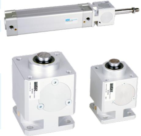
Am vorderen Zylinderkopf ist eine Kolbenstangenbremse BH mit mechanischer Klemmung montiert. Die Bremse ist im Ruhezustand durch Federkraft aktiviert und wird durch Druckbeaufschlagung gelöst. Die Betätigung der Bremse darf nur im statischen Zustand des Systems erfolgen.
