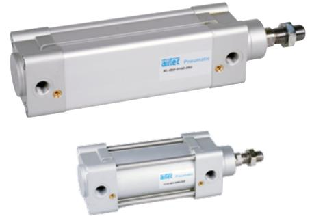
Doppeltwirkender Pneumatikzylinder, beidseitig mit einstellbarer, pneumatischer Endlagendämpfung. Mit Positionserkennung zur berührungslosen Stellungsabfrage mit Zylinderschaltern. Sonderhublängen sind auf Wunsch lieferbar.
