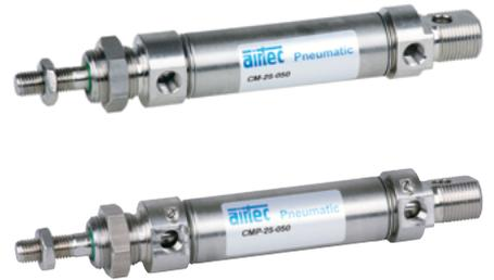
Doppeltwirkender Pneumatikzylinder mit Dämpfungsscheiben in den Endlagen und Positionserkennung zur berührungslosen Stellungsabfrage mit Zylinderschaltern. Der Zylinder ist auch mit einstellbarer, pneumatischer Endlagendämpfung lieferbar. Zylinderkopf und -boden sind mit dem Zylinderrohr durch Rollieren verbunden.
