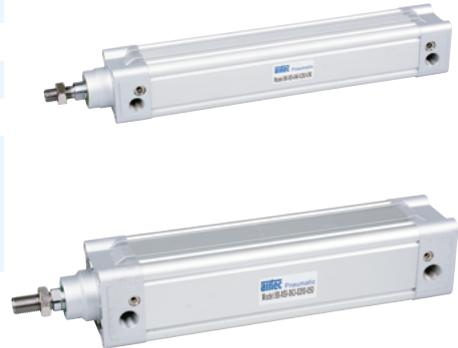
Doppelwirkender Pneumatikzylinder, beidseitig mit einstellbarer, pneumatischer Endlagendämpfung. Mit Positionserkennung zur berührungslosen Positionsabfrage mit Zylinderschaltern.
