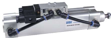
Doppeltwirkender Pneumatikzylinder, beidseitig mit einstellbarer, pneumatischer Endlagendämpfung. Mit Positionserkennung zur berührungslosen Stellungsabfrage mit Zylinderschaltern. Sonderhublängen sind auf Wunsch lieferbar.
