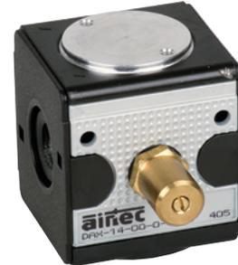
Anfahrventil zum langsamen Druckaufbau in Druckluftsystemen. Die Betätigung erfolgt durch den Sekundärdruck. Nach Erreichen von 50% des Ausgangsdrucks schaltet das Ventil komplett durch. Die Füllzeit ist einstellbar.
