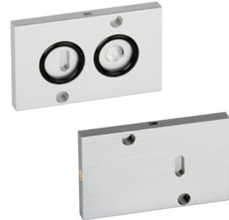
Wendeplatte zur Verwendung von 5/2-Wege-NAMUR-Ventilen als 3/2-Wege-Ventil. Durch Drehung der Wendeplatte um 180° lässt sich die Funktion NC in NO umstellen.
