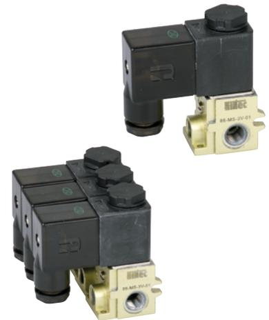
Elektrisch betätigtes Sitzventil. Nach Zuschalten der Spannung wird das Ventil umgesteuert. Die Ventile sind mit einer rastenden Handhilfsbetätigung ausgestattet. Die Betätigung erfolgt mittels Schraubendreher.
