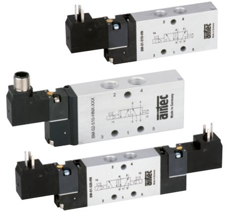
Elektrisch betätigtes Kolbenschieber-Ventil. Nach Zuschalten der Spannung wird das Ventil umgesteuert. Die Ventile sind mit einer rastenden (HNR) oder tastenden Handhilfsbetätigung (HNT) ausgestattet. Die Betätigung erfolgt mittels geeignetem Werkzeug.
