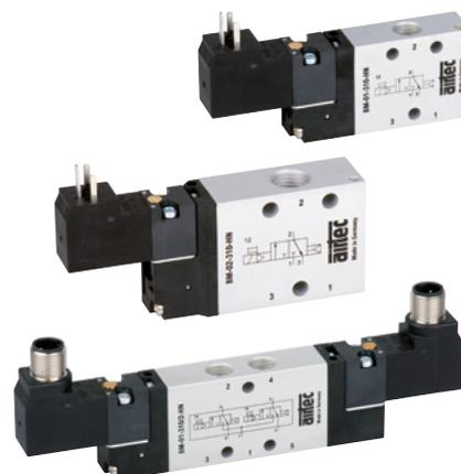
Elektrisch betätigtes Kolbenschieber-Ventil. Nach Zuschalten der Spannung wird das Ventil umgesteuert. Die Ventile sind mit einer rastenden (HNR) oder tastenden Handhilfsbetätigung (HNT) ausgestattet. Die Betätigung erfolgt mittels geeignetem Werkzeug.
