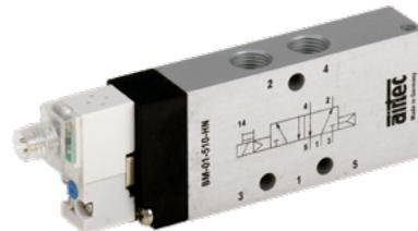
Elektrisch betätigtes Kolbenschieber-Ventil. Nach Zuschalten der Spannung wird das Ventil umgesteuert. Die Ventile sind mit einem M8-Magnetsystem mit einer tastenden Handhilfsbetätigung (HNT) ausgestattet. Die Betätigung erfolgt mittels geeignetem Werkzeug.
