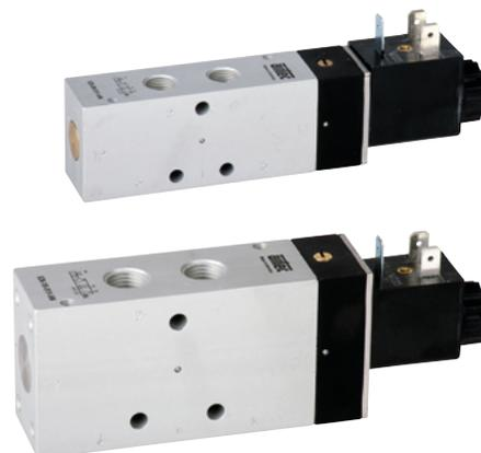
Elektrisch betätigtes Kolbenschieber-Ventil. Nach Zuschalten der Spannung wird das Ventil umgesteuert. Die Ventile sind mit einer rastenden Handhilfsbetätigung ausgestattet. Die Betätigung erfolgt mittels Schraubendreher.
