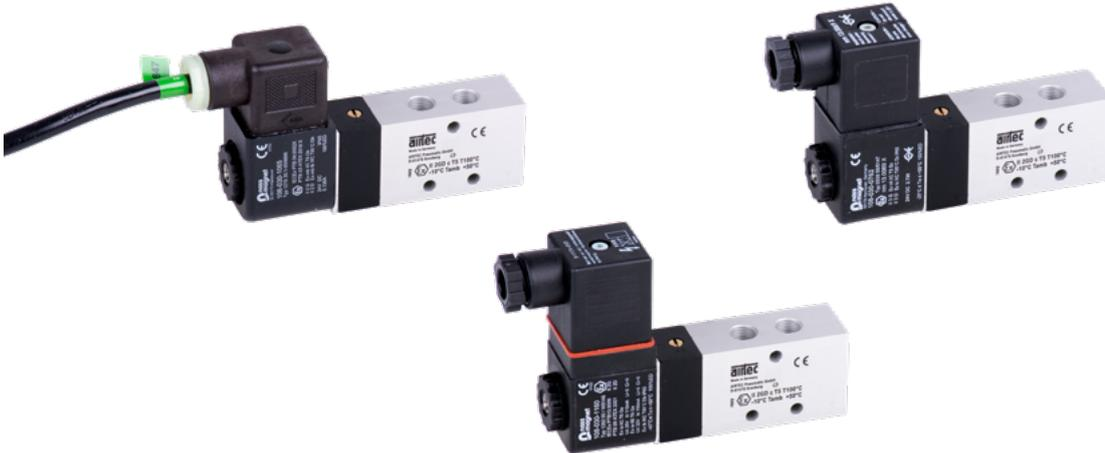
Damit entsprechen sie der Gerätekategorie 2 und können ab der Zone 1 bzw. 21 eingesetzt werden. Für den Einsatz in explosionsgefährdeter Umgebung ist zusätzlich die Gerätekategorie der verwendeten Magnetspule zu beachten. Für die Baugruppe ist immer die niedrigste Gerätekategorie der Komponenten zu verwenden.
