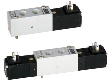
Elektrisch betätigtes Kolbenschieber-Ventil. Nach Zuschalten der Spannung wird das Ventil umgesteuert. Die Ventile sind mit einer rastenden Handhilfsbetätigung ausgestattet. Die Betätigung erfolgt mittels Schraubendreher. Die Befestigungsschrauben und die Dichtungen für die Grundplattenmontage gehören zum Lieferumfang.
