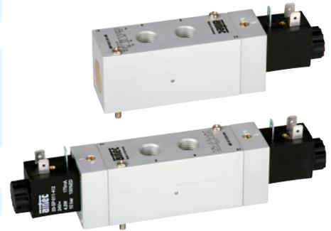
Elektrisch betätigtes Kolbenschieber-Ventil. Nach Zuschalten der Spannung wird das Ventil umgesteuert. Die Ventile sind mit einer rastenden Handhilfsbetätigung ausgestattet. Die Betätigung erfolgt mittels Schraubendreher. Die Befestigungsschrauben für die Grundplattenmontage gehören zum Lieferumfang.
