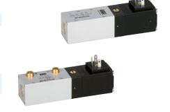
Elektrisch betätigtes Kolbenschieber-Ventil. Nach Zuschalten der Spannung wird das Ventil umgesteuert. Die Ventile sind mit einer rastenden Handhilfsbetätigung ausgestattet. Die Betätigung erfolgt mittels Schraubendreher. Die Befestigungsschrauben und die Dichtungen für die Grundplattenmontage gehören zum Lieferumfang.
