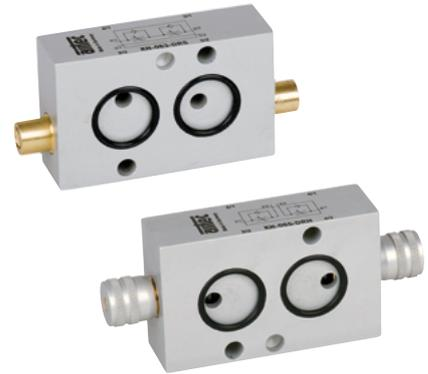
Drosselplatten zur Geschwindigkeitsregulierung von Stellantrieben. Der Betrieb erfolgt in Kombination mit NAMUR-Ventilen. Einstellung mittels Schraubendreher oder Handrad. Befestigungsschrauben, Codierstift und O-Ringe gehören zum Lieferumfang.
