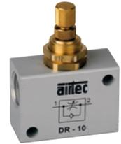
Die in Drosselrichtung strömende Luftmenge kann durch Verstellen der Drosselspindel reguliert werden. Gegen Drosselrichtung strömt die Luft ungedrosselt über ein Rückschlagventil. Die Drosselspindel ist gegen ungewollte Verstellung durch einen Reibring in der Verstellbuchse gesichert, bei dem Ventil DR-10 erfolgt die Sicherung durch eine Kontermutter. Die Reibkraft ist so bemessen, daß die Spindel von Hand leicht gedreht werden kann.
