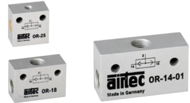
Am Ausgang 2 erscheint ein Signal, wenn entweder am Eingang 12 oder am Eingang 14 ein Signal ansteht. Wenn an beiden Eingängen Signale anstehen, gelangt der höhere Druck zum Ausgang. Das ODER-Glied hat als passives Element keine eigene Entlüftung. Nach Löschen des Eingangssignals wird über die vorgeschalteten Signalglieder entlüftet.
