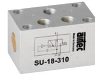
Dieses Ventil unterbricht ein Dauersignal, so dass am Ausgang ein Impuls von ca. 0,3 s entsteht. Ein bei 1 ankommendes Signal hat Durchfluss zum Ausgang 2. Nach 0,3 s schaltet der im Ventil entstandene Druck den Kolben um. Anschluss 1 wird gesperrt, Ausgang 2 entlüftet nach 3. Nach Löschen des Signals stellt eine Feder den Kolben sofort zurück.
