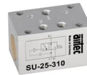
Dieses Ventil unterbricht ein Dauersignal, so dass am Ausgang ein Impuls von ca. 0,3 s entsteht. Ein bei 1 ankommendes Signal hat Durchfluss zum Ausgang 2. Nach 0,3 s schaltet der im Ventil entstandene Druck den Kolben um. Anschluss 1 wird gesperrt, Ausgang 2 entlüftet nach 3. Nach Löschen des Signals stellt eine Feder den Kolben sofort zurück.
