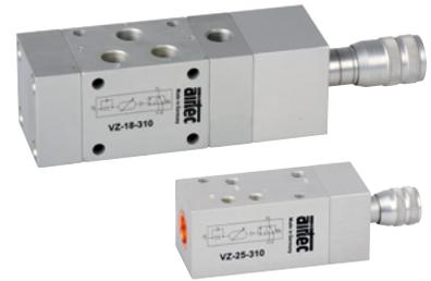
Pneumatisch betätigtes Kolbenschieber-Ventil mit einstellbarer Einschaltverzögerung. Durch Druckbeaufschlagung wird das Ventil nach Ablauf der eingestellten Zeit umgesteuert. Nach Löschen des Signals wird das Ventil sofort zurück gestellt. Druckanschluss bei 1 ergibt die Funktion „Ruhestellung geschlossen“, Druckanschluss bei 3 die Funktion „Ruhestellung offen“.
