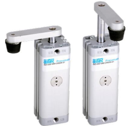
Doppeltwirkender Pneumatikzylinder mit integrierten Dämpfungsscheiben. Durch die Kombination aus Linear- und Schwenkbewegung der Kolbenstange sind kombinierte Einlege- und Spannvorgänge realisierbar. Sonderwinkel und Sonderhublängen sind auf Wunsch lieferbar.
