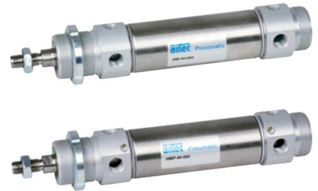
Doppeltwirkender Pneumatikzylinder mit Dämpfungsscheiben in den Endlagen und Positionserkennung zur berührungslosen Stellungsabfrage mit Zylinderschaltern. Der Zylinder ist auch mit einstellbarer, pneumatischer Endlagendämpfung lieferbar. Zylinderkopf und -boden sind mit dem Zylinderrohr durch Rollieren verbunden. Sonderhublängen sind auf Wunsch lieferbar.
