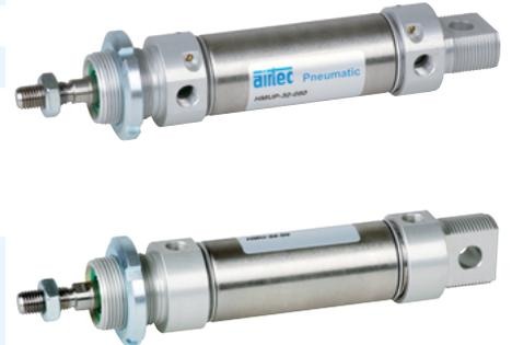
Doppelwirkender Pneumatikzylinder mit Dämpfungsscheiben in den Endlagen und Positionserkennung zur berührungslosen Stellungsabfrage mit Zylinderschaltern. Der Zylinder ist auch mit einstellbarer, pneumatischer Endlagendämpfung lieferbar. Zylinderkopf und -boden sind mit dem Zylinderrohr durch Rollieren verbunden.
