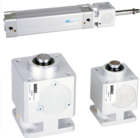
Am vorderen Zylinderkopf ist eine Kolbenstangenbremse BH mit mechanischer Klemmung montiert. Die Bremse ist im Ruhezustand durch Federkraft aktiviert und wird durch Druckbeaufschlagung gelöst. Die Betätigung der Bremse darf nur im statischen Zustand des Systems erfolgen.
