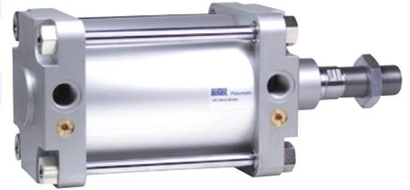
Doppeltwirkender Pneumatikzylinder, beidseitig mit einstellbarer, pneumatischer Endlagendämpfung. Mit Positionserkennung zur berührungslosen Stellungsabfrage mit Zylinderschaltern. Sonderhublängen sind auf Wunsch lieferbar.
