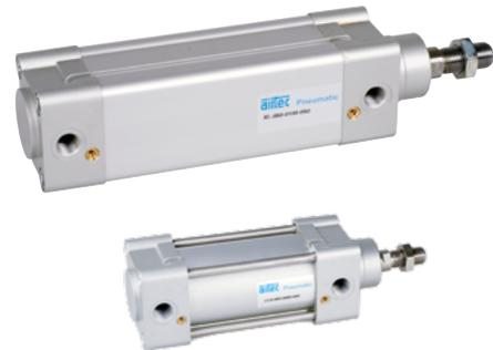
Doppelwirkender Pneumatikzylinder, beidseitig mit einstellbarer, pneumatischer Endlagendämpfung. Mit Positionserkennung zur berührungslosen Stellungsabfrage mit Zylinderschaltern. Sonderhublängen sind auf Wunsch lieferbar.
