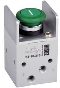
Mechanisch betätigtes, vorgesteuertes Kolbenschieber-Ventil mit montiertem Betätiger. Die Vorsteuerung bedingt eine geringe Betätigungskraft und einen Eigenluftverbrauch.
