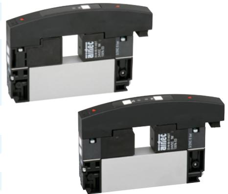
Elektrisch betätigtes Kolbenschieber-Ventil. Nach Zuschalten der Spannung wird das Ventil umgesteuert. Die Ventile sind mit einer tastenden und rastenden Handhilfsbetätigung ausgestattet. Die Betätigung erfolgt über den Terminaldeckel mittels Schraubendreher.
