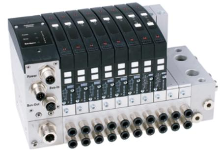
Ventil-/Grundplattensystem mit elektrischem Sammelanschluss, integrierter LED- Anzeige und Schutzbeschaltung. Das Ventil-Terminal kann beliebig mit 2 x 3/2-Wege-Ventilen, einem 5/2- oder 5/3-Wege-Ventil auf jeder Station bestückt werden. Alle Anschlüsse sind von der Vorderseite zugänglich.
