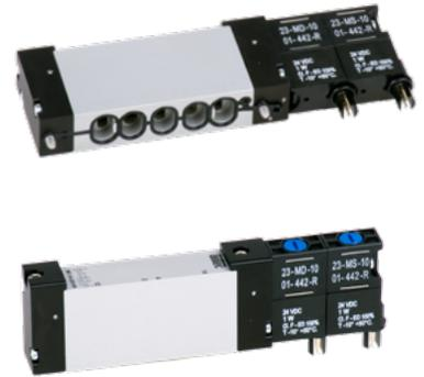
Elektrisch betätigtes Kolbenschieber-Ventil. Nach Zuschalten der Spannung wird das Ventil umgesteuert. Die Ventile sind mit einer tastenden oder rastenden Handhilfsbetätigung ausgestattet. Die Betätigung erfolgt am Magnet.
